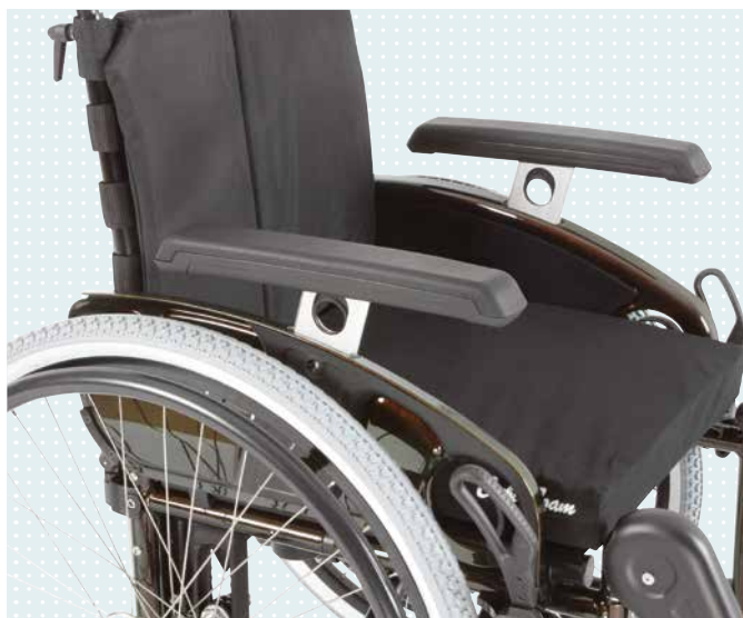
• Braccioli regolabili in altezza ribaltabili ed estraibili, con spondina in alluminio
